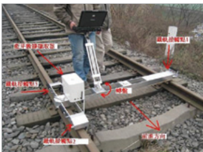
/ 轨检系统的结构组成 /
